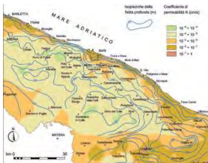
Fig. 2 - Isopieziche della falda idrica profonda e distribuzione del coefficiente di permeabilità dell'acquifero carbonatico appartenente all'area idrogeologica della Murgia.
