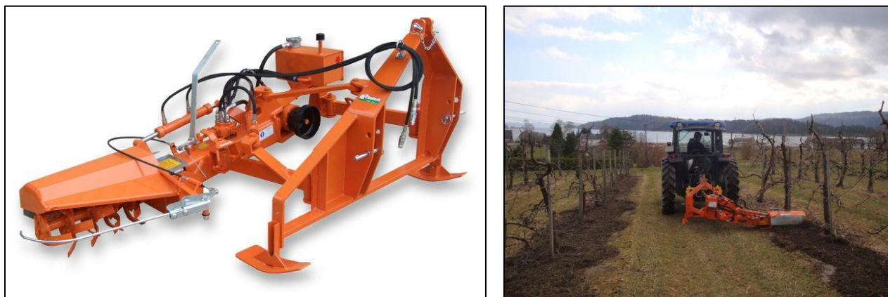
Figura 5.3: Esempio di fresatrice interceppo per le lavorazioni sulla fila (Foto: Rinieri S.r.l.)
