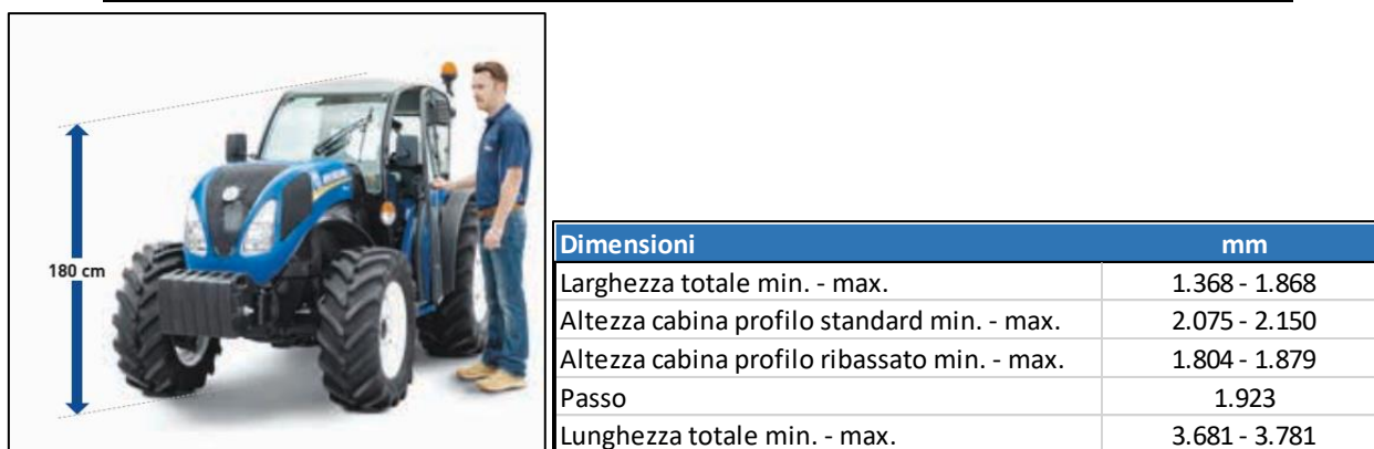
Figura 7.1: Dimensioni caratteristiche di un trattore da frutteto con cabina ribassata (Fonte: CNH)
