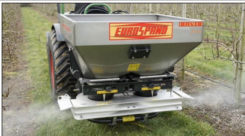
Figura 7.4: esempio di spandiconcime localizzato mono/bilaterale per frutteti (Foto: EuroSpand)
