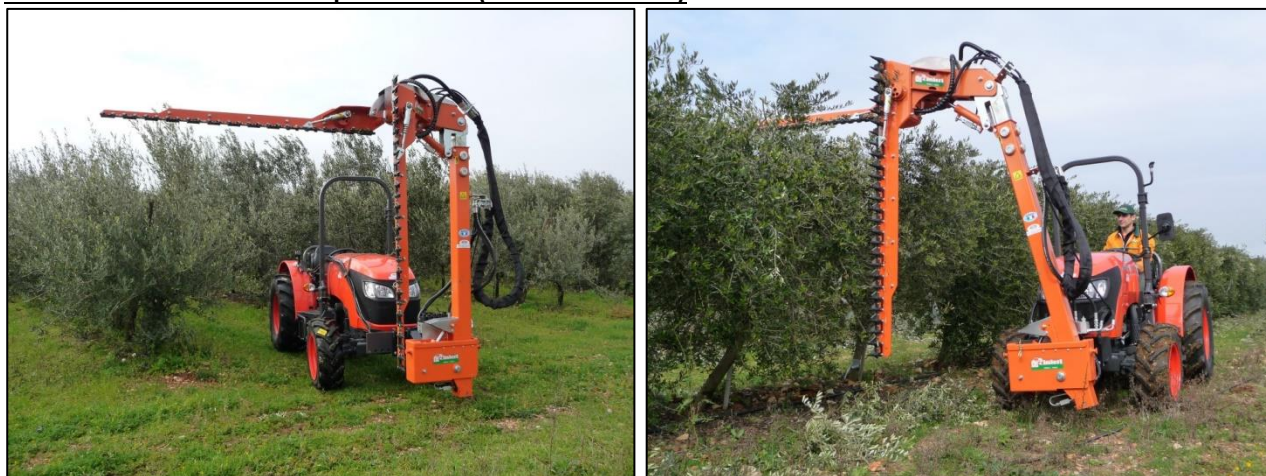
Figura 7.3: Esempio di potatrice meccanica frontale a doppia barra (taglio verticale + topping) utilizzabile su tutti le colture arboree intensive e superintensive (Foto: Rinieri S.r.l.)
