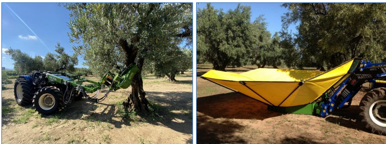
Fig. 6.10-6.11: Mezzi per la raccolta meccanica delle olive (foto: SICMA)
