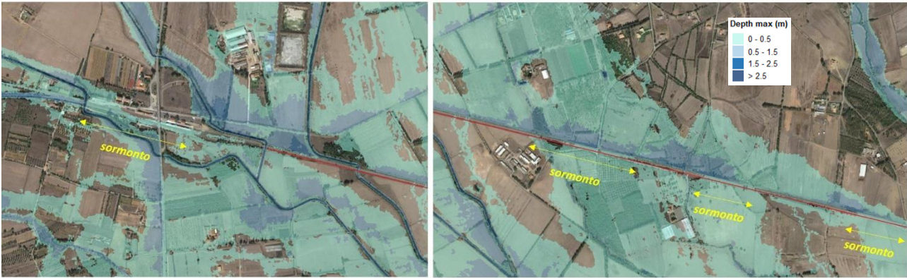
Figura 26: Modello numerico 2D del Riu Cixerri, ante operam, Tr200 – aree di esondazione – Tratta 4 “Punto intermedio (Nuovo P.C.) - Villamassargia”, in arrivo a Villamassargia.
