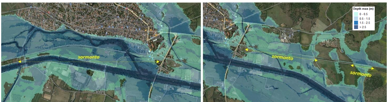
Figura 22: Modello numerico 2D del Riu Cixerri, ante operam, Tr200 – aree di esondazione – Tratta 3 “Siliqua (stazione inclusa) – Punto intermedio (Nuovo P.C.)”, in quel di Siliqua.
