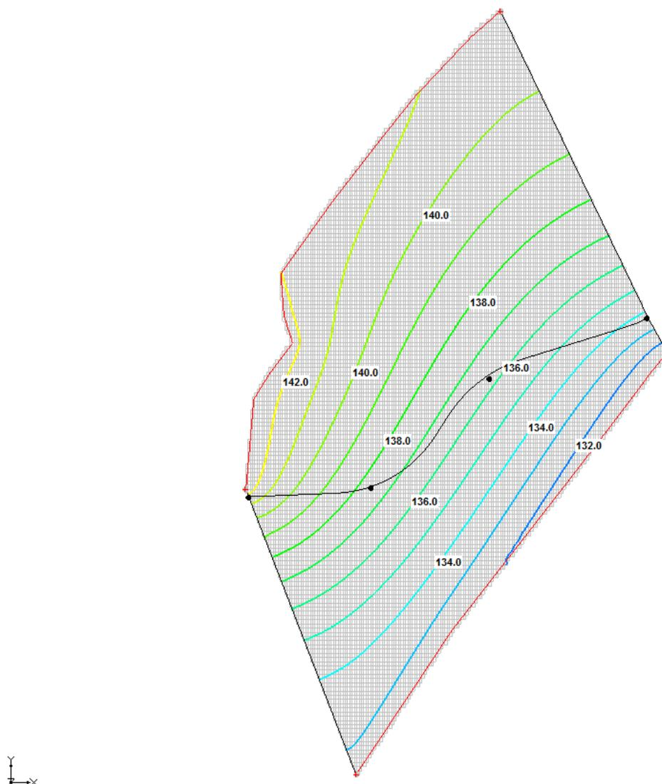
*Figura 5-4: Andamento delle isofreatiche nello stato attuale (piezometria Maggio 2013)*
