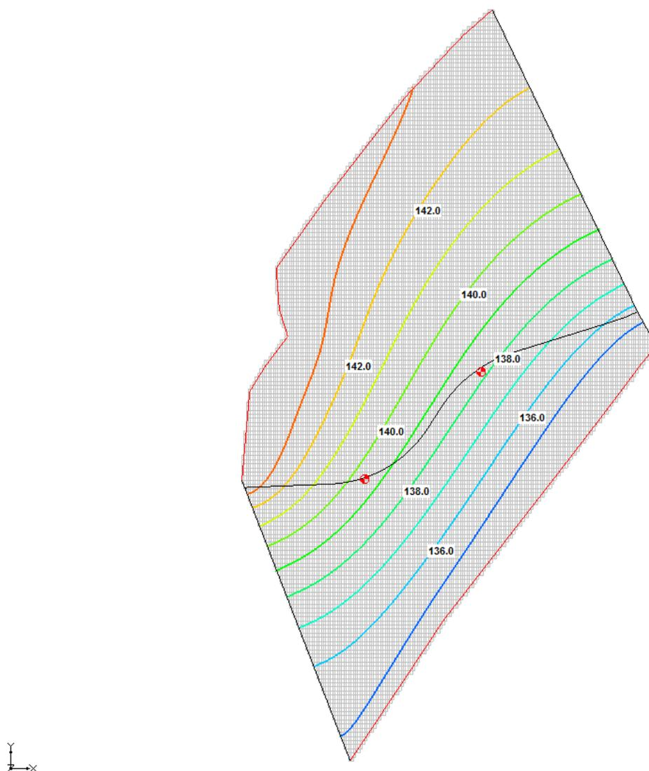
*Figura 6-1: Andamento della falda di progetto a breve termine ricostruita con il modello*
