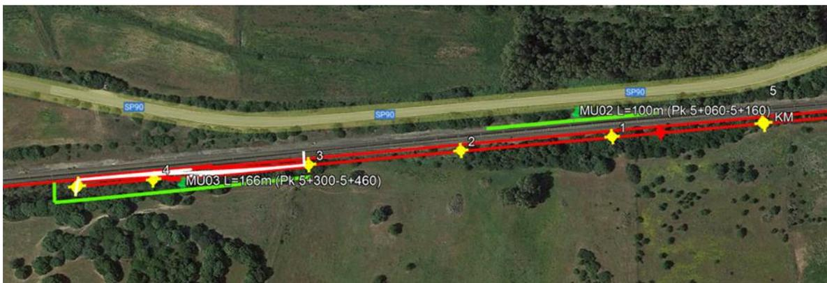
Figura 3-1 – Ubicazione planimetrica opera di sostegno MU03 pk 5+300-5+460 (L=166m)
