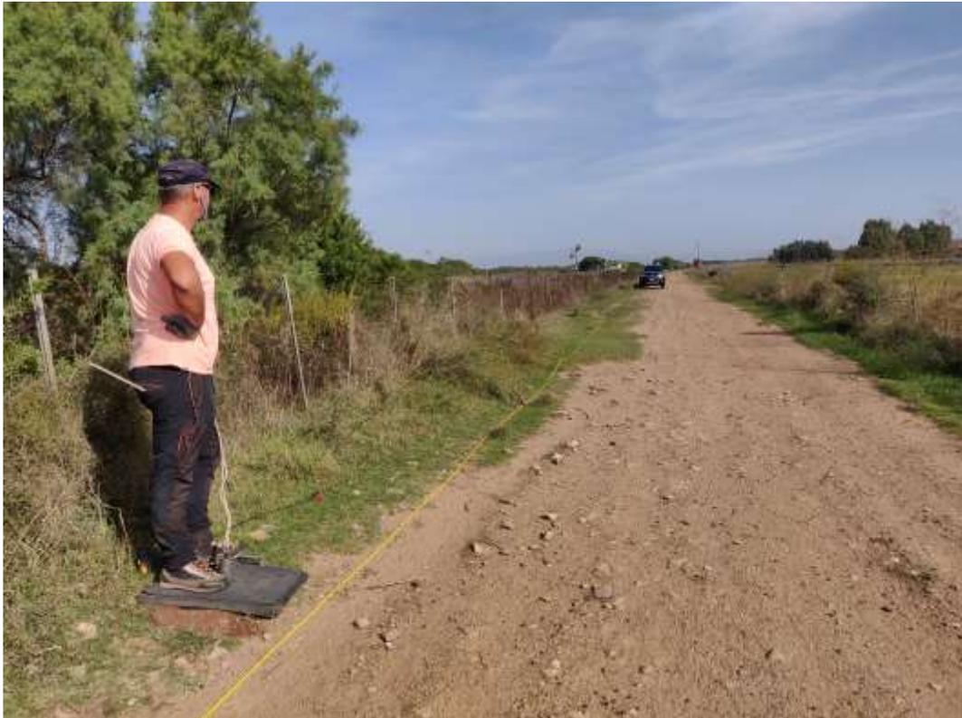
*Figura 8-6: Foto relativa all'esecuzione della prova Sismicas a Rifrazione R2\_LOTTO2.*
