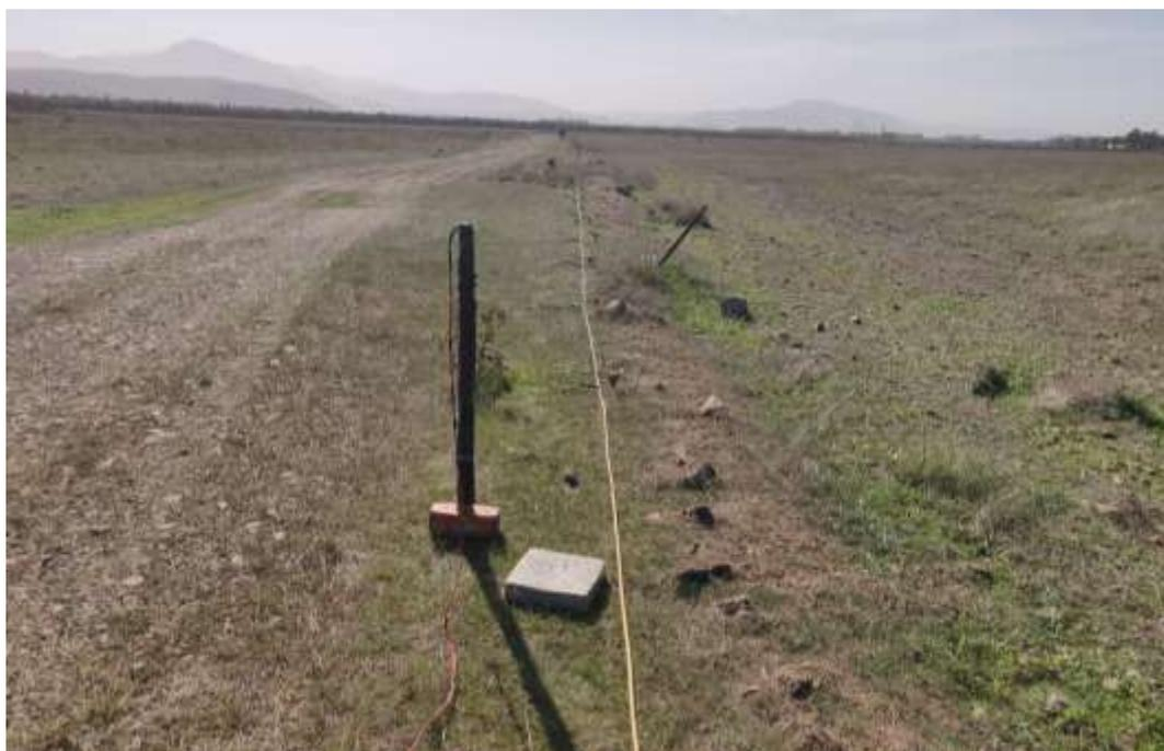
*Figura 4-2: Foto relativa all'esecuzione della prova MASW1\_LOTTO2.*
