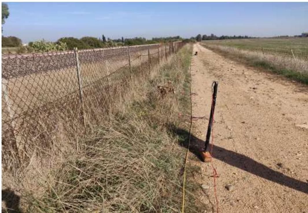
*Figura 4-9: Foto relativa all'esecuzione della prova MASW2\_LOTTO2.*
