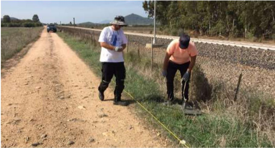
*Figura 8-2: Foto relativa all'esecuzione della prova Sismica a Rifrazione R1\_LOTTO2.*
