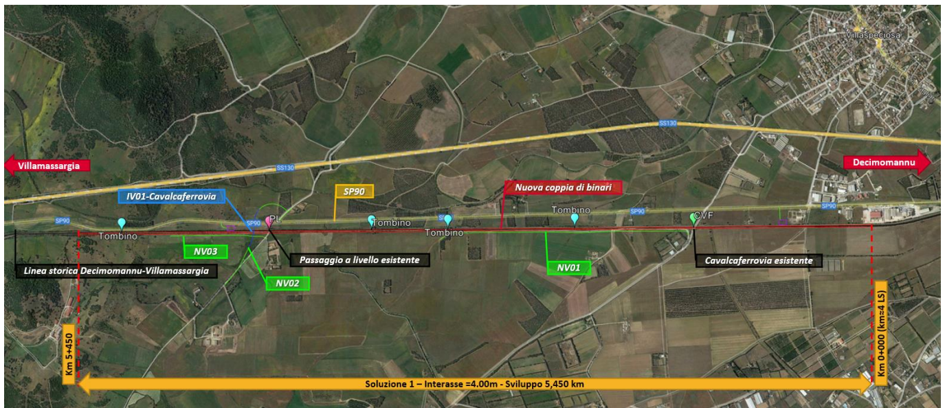
Figura 11– Planimetria soluzione 1 - raddoppio in sede in stretto affiancamento a 4.00m e innalzamento del piano del ferro
