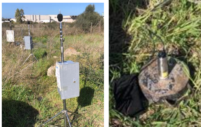
Figura 4-2 Esempio di installazione dell'accelerometro
