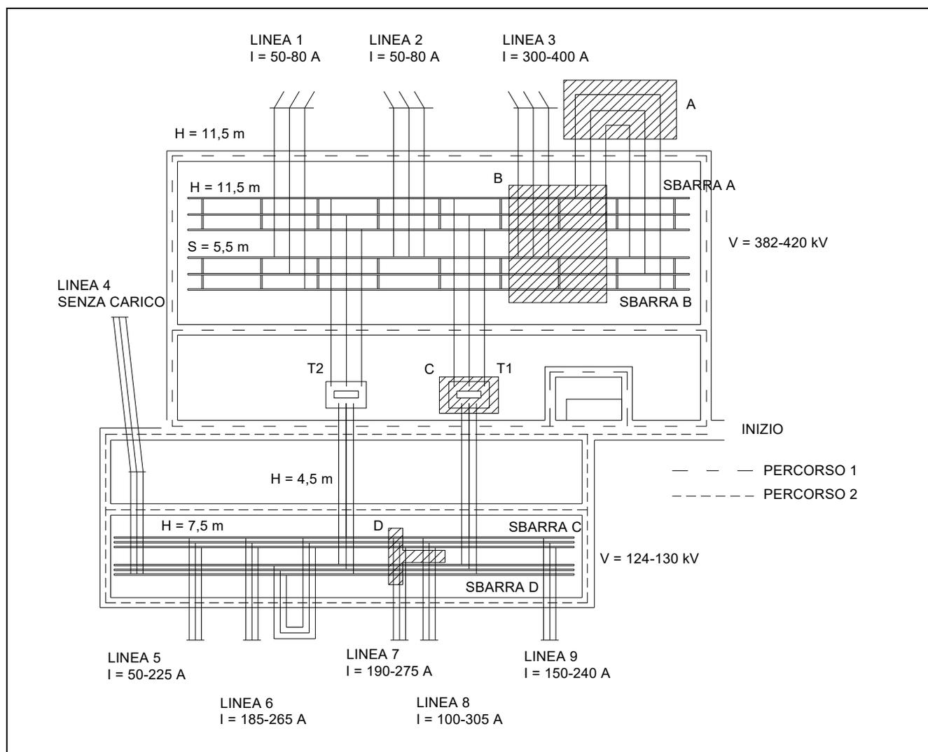
**Fig. 1** – Pianta di una tipica stazione 380/132 kV con l'indicazione delle principali distanze fase-fase (S) e fase-terra (H) e delle variazioni delle tensioni e delle correnti durante la fasi di misurazioni di campo elettrico e magnetico.
