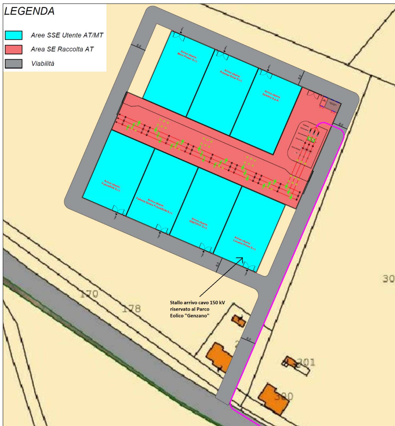
Figura 2.3.5.1: Layout della Stazione Elettrica Condivisa
