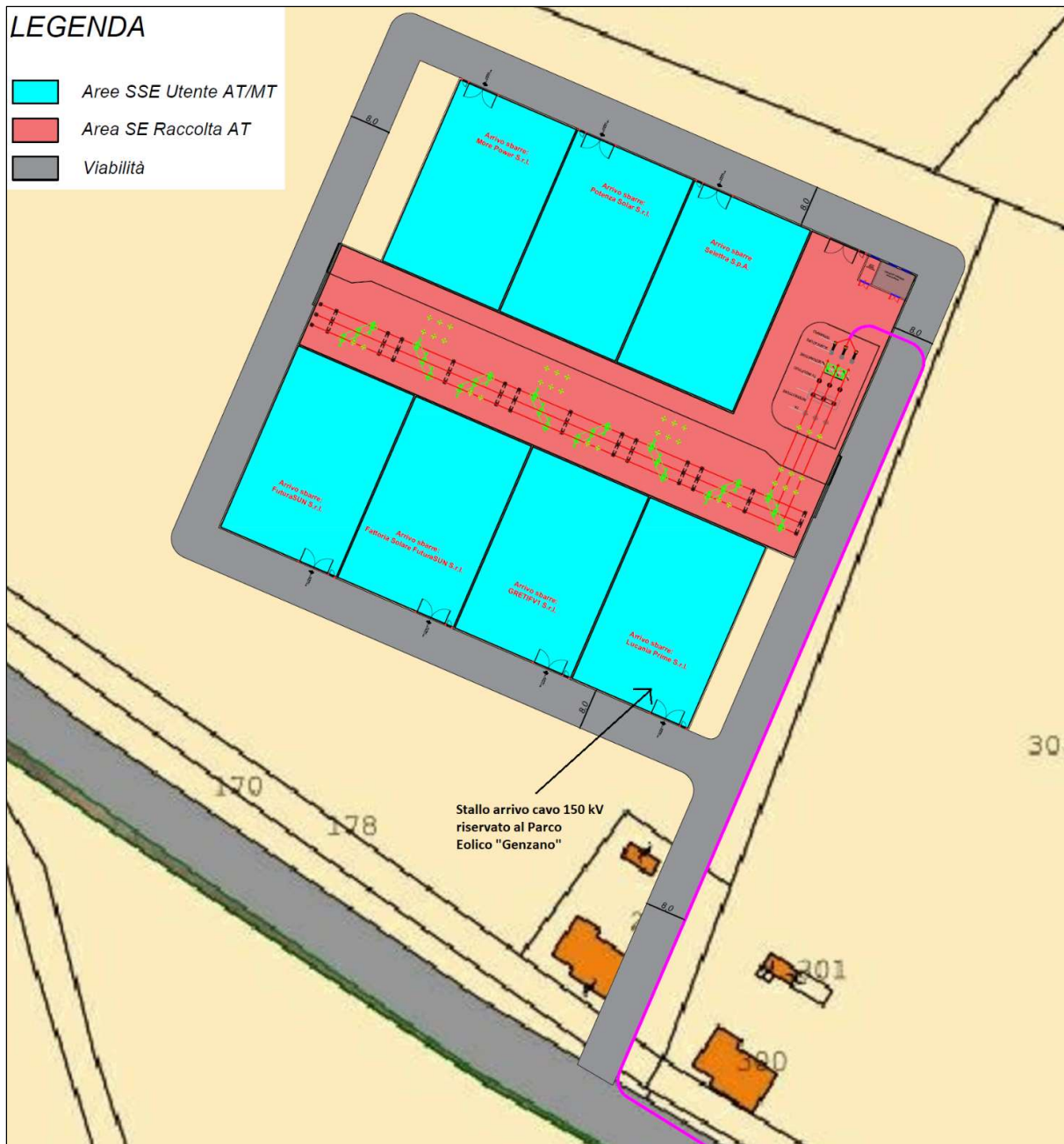
Figura 6.3.5.1: Layout della Stazione Elettrica Condivisa
