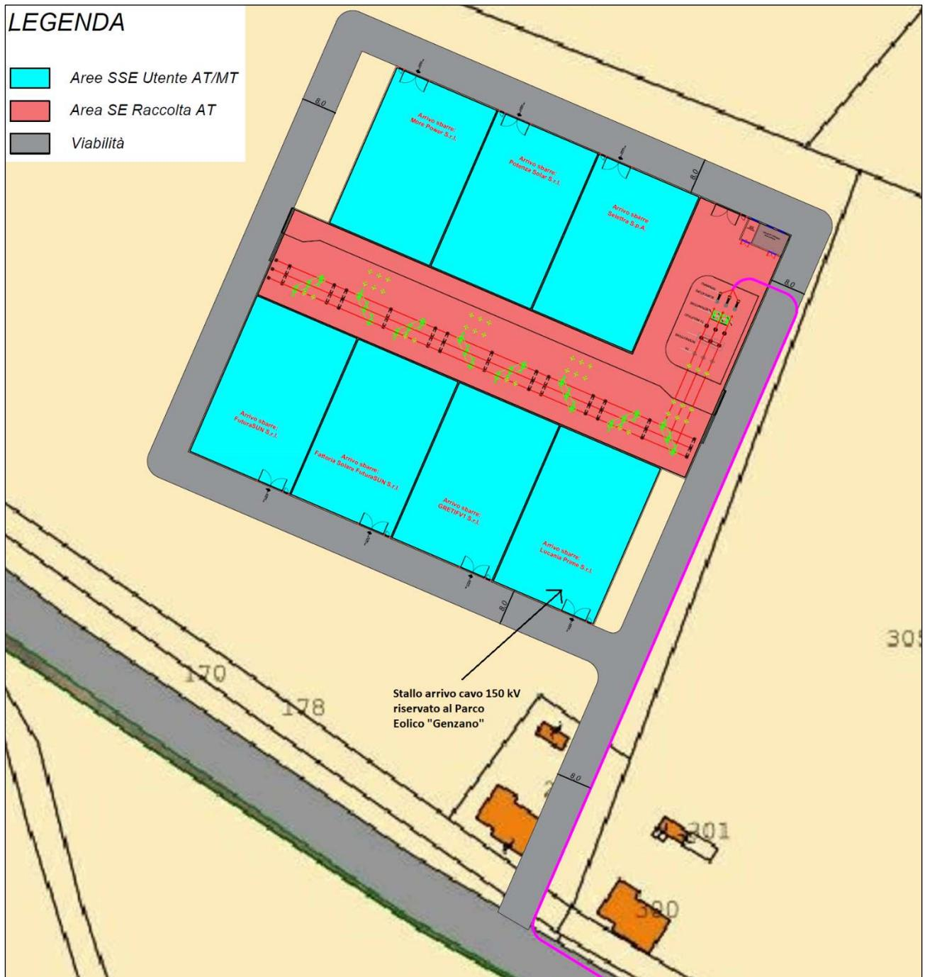
**Figura 2.4.1:** Planimetria elettromeccanica della sottostazione elettrica condivisa
