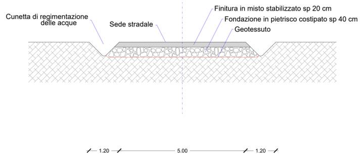
SEZIONE TIPO-SEZIONE IN RILEVATO\_SCALA 1:50
