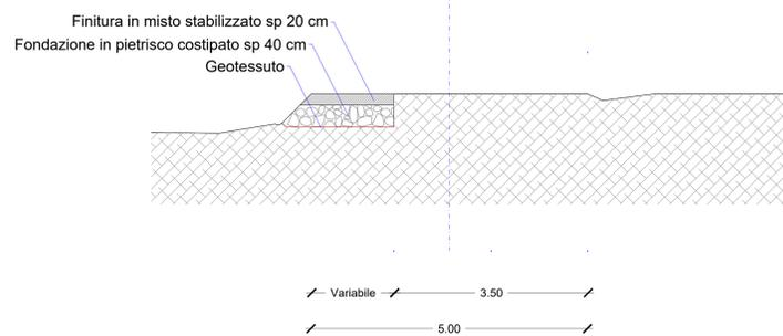
SEZIONE TIPO-ADEGUAMENTO VIABILITA' ESISTENTE\_SCALA 1:50
