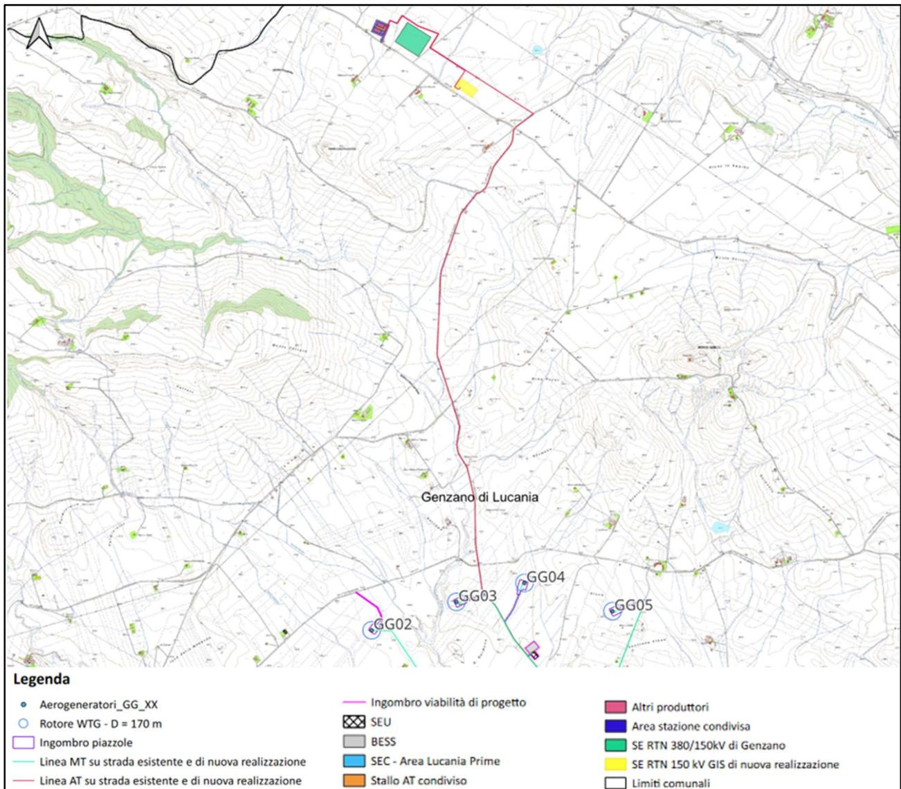
**Figura 2.2:** Soluzione di connessione a 150 kV in corrispondenza della stazione elettrica RTN Terna 380/150 kV di Genzano
