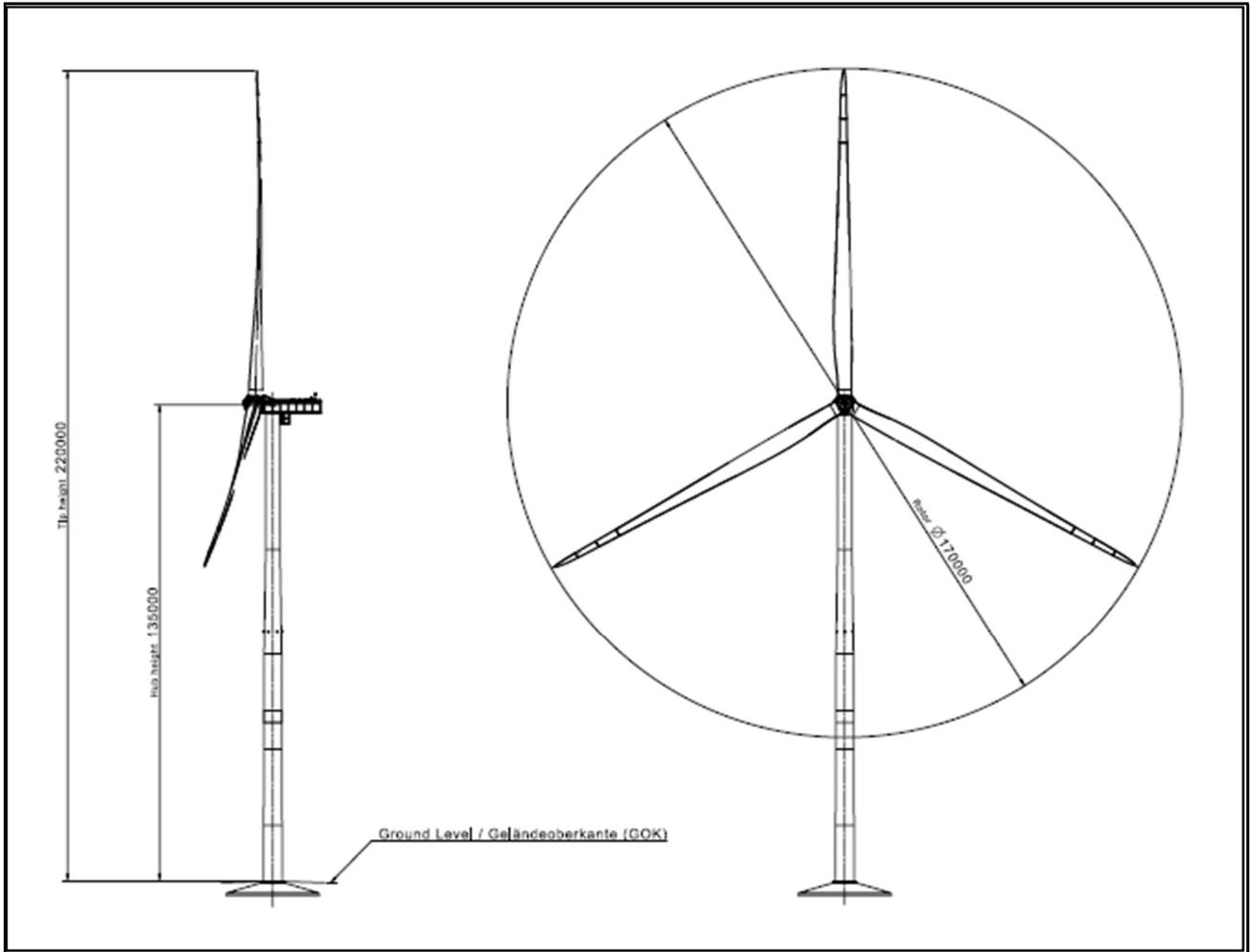
Figura 2.1.1: Profilo aerogeneratore SG170 – 6.2 MW
