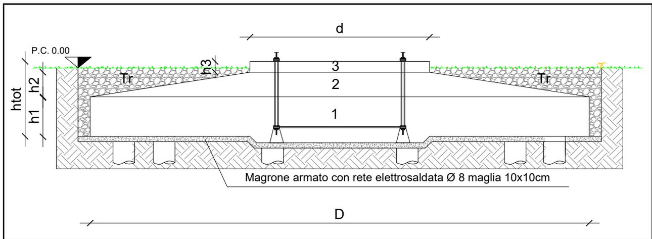
Figura 5.1.2: Dettaglio modello per calcolo volumi
