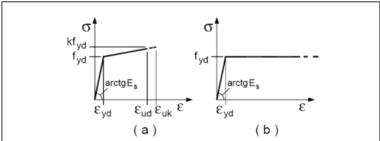
Figura 4.1.2.1: Diagrammi di calcolo tensione/deformazione dell'acciaio
