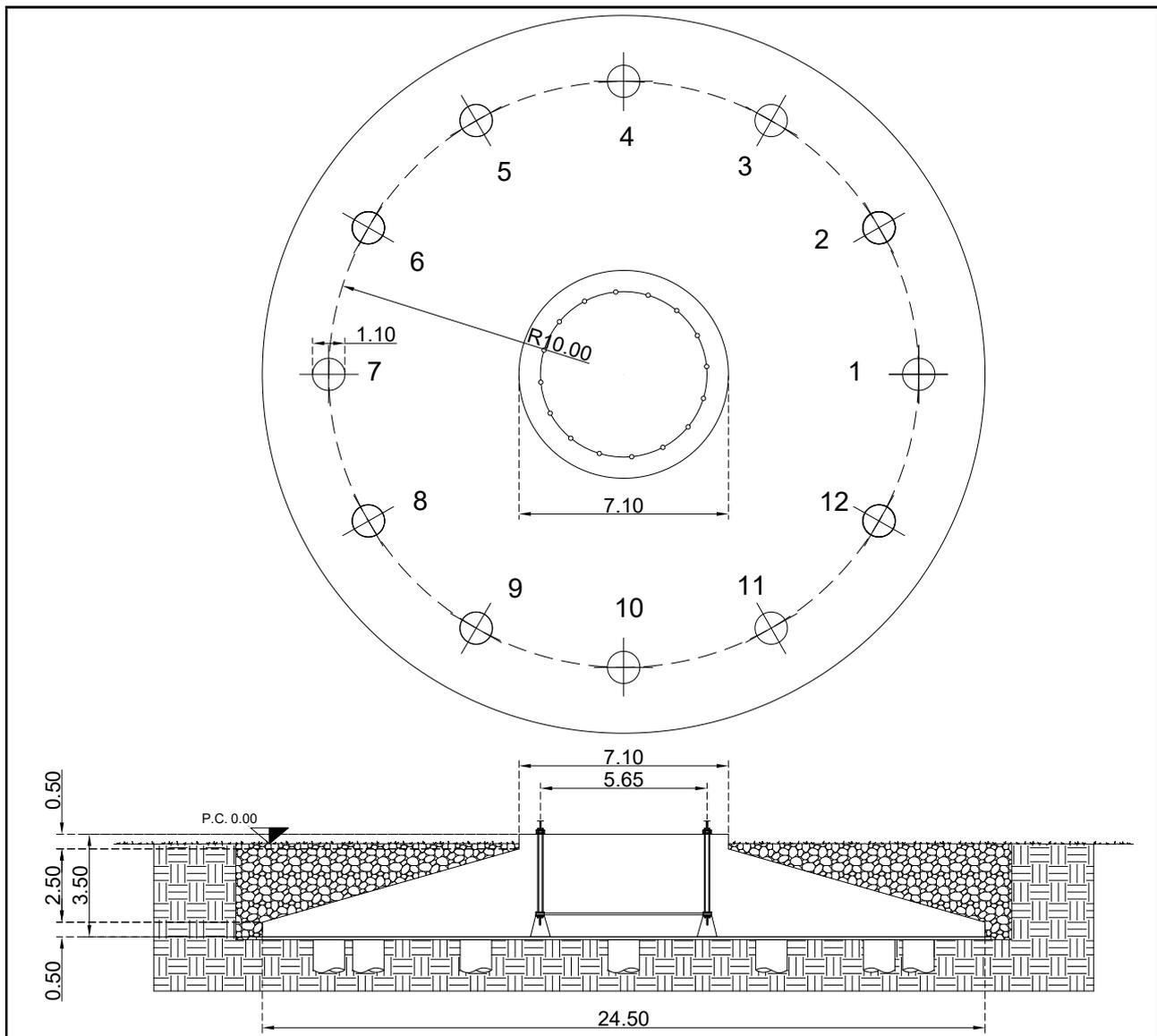
**Figura 5.1.1:** Dettaglio pianta e sezione fondazione
