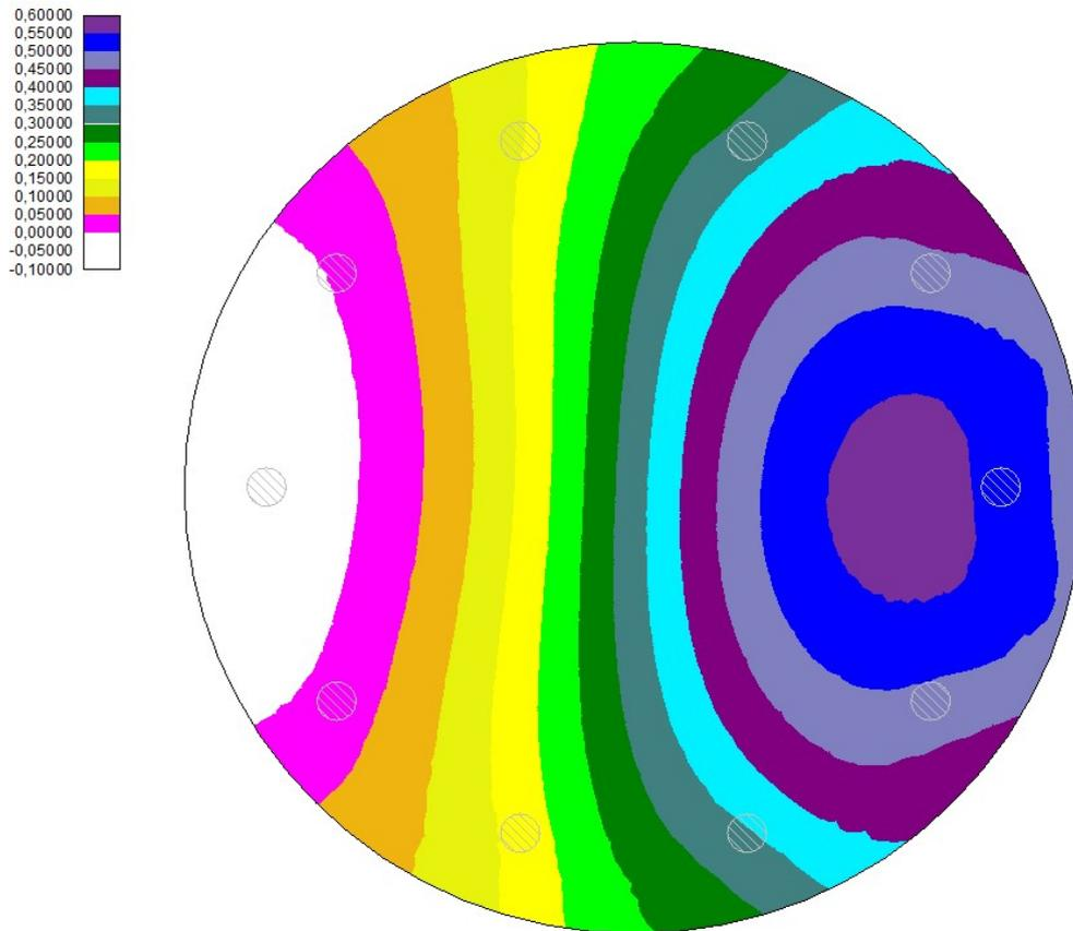
Figura 10.1.1 – Diagramma dei cedimenti (*unità di misura cm*)
