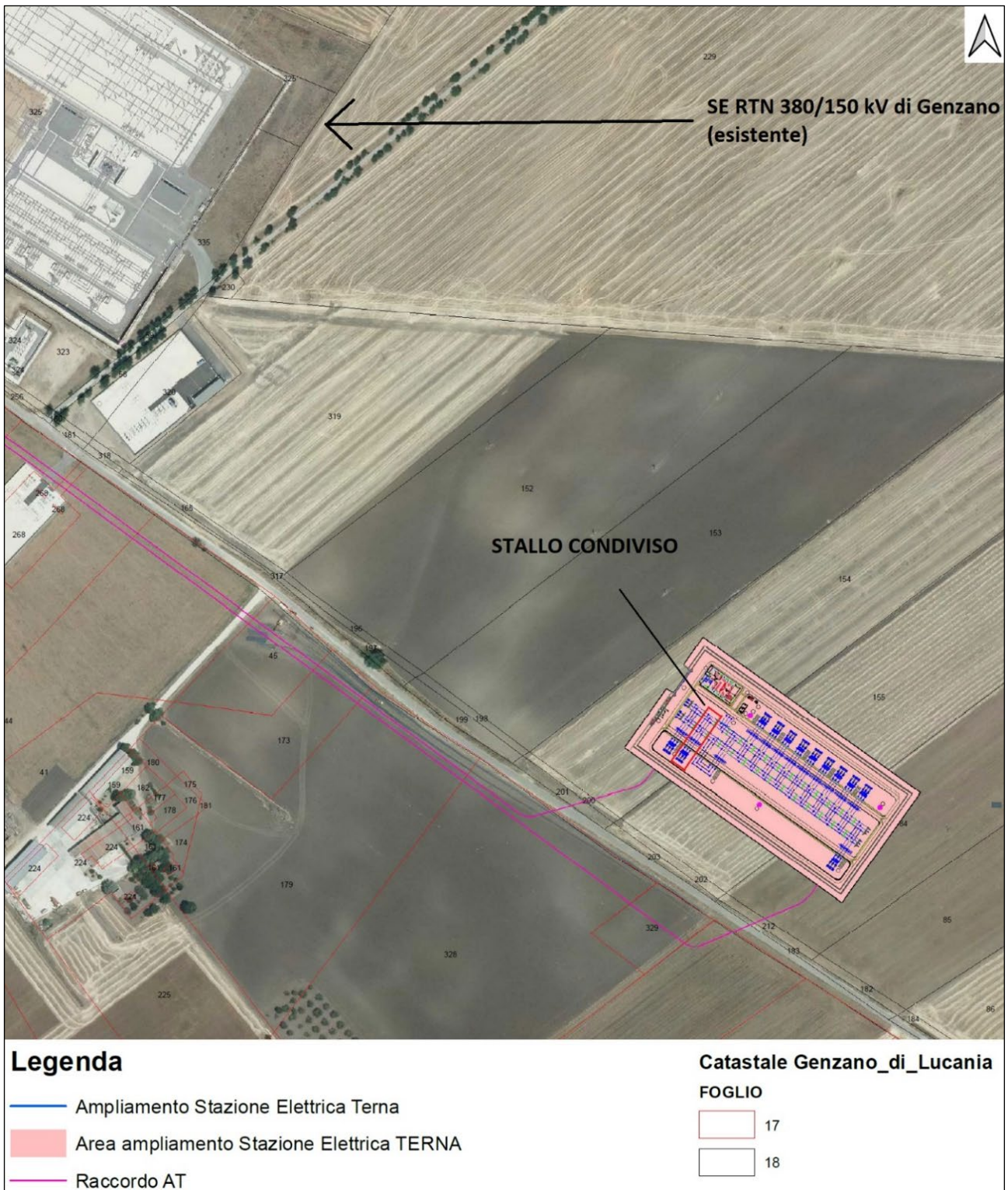
Figura 11.1: Individuazione su ortofoto e catastale dello stallo AT condiviso nell'ampliamento della SE RTN Terna di Genzano
