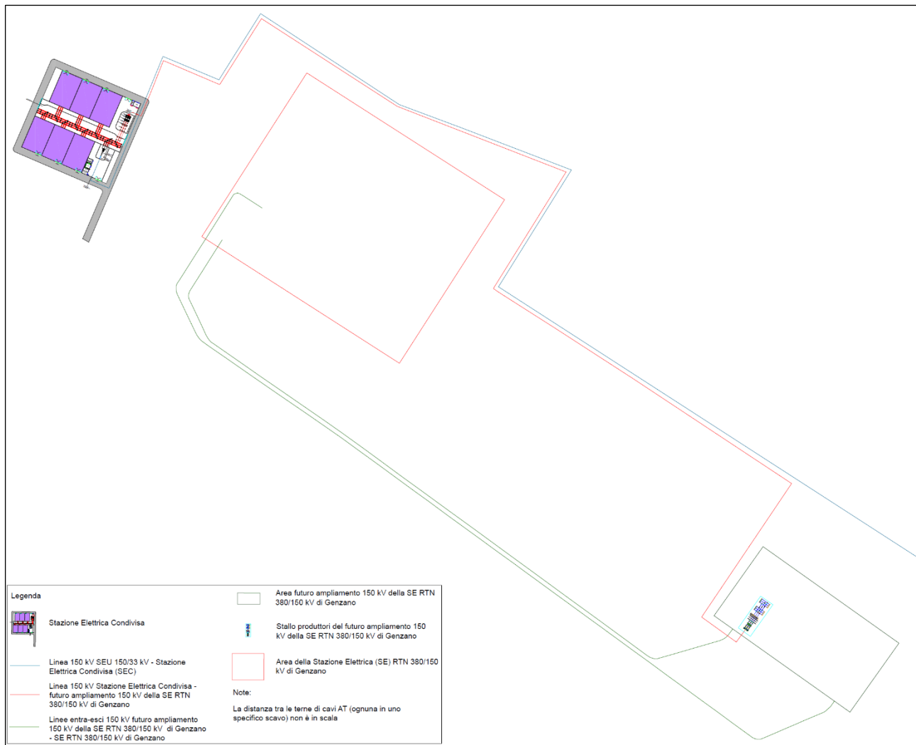
Figura 5.1.6: Dettaglio 4 – collegamento tra la SEC e l'ampliamento a 150 kV della SE RTN 380/150 kV e collegamento in entra-esce tra il medesimo ampliamento e la SE RTN 380/150 kV
