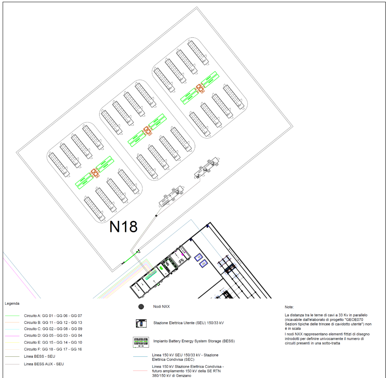
Figura 8.3: Layout del BESS con cavi di collegamento al quadro a 33 kV della SEU 150/33 kV
