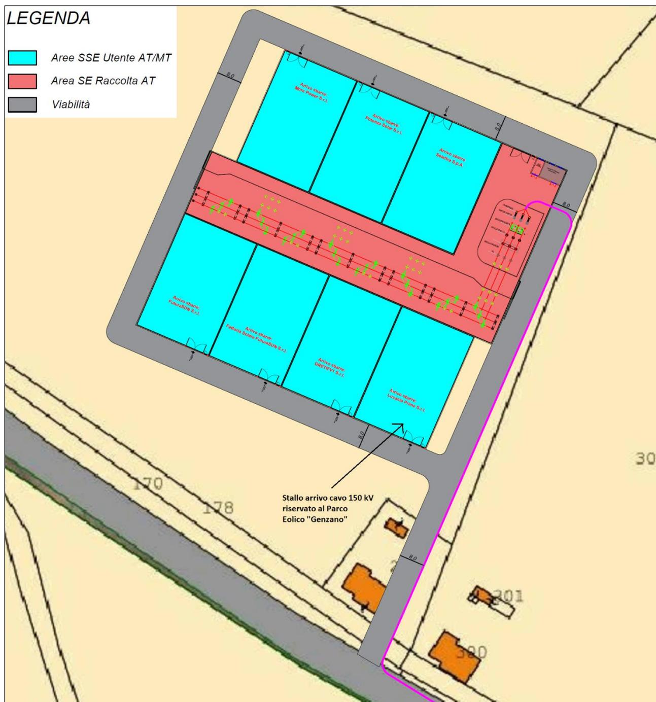
**Figura 2.3.4.1:** Planimetria elettromeccanica della sottostazione elettrica condivisa
