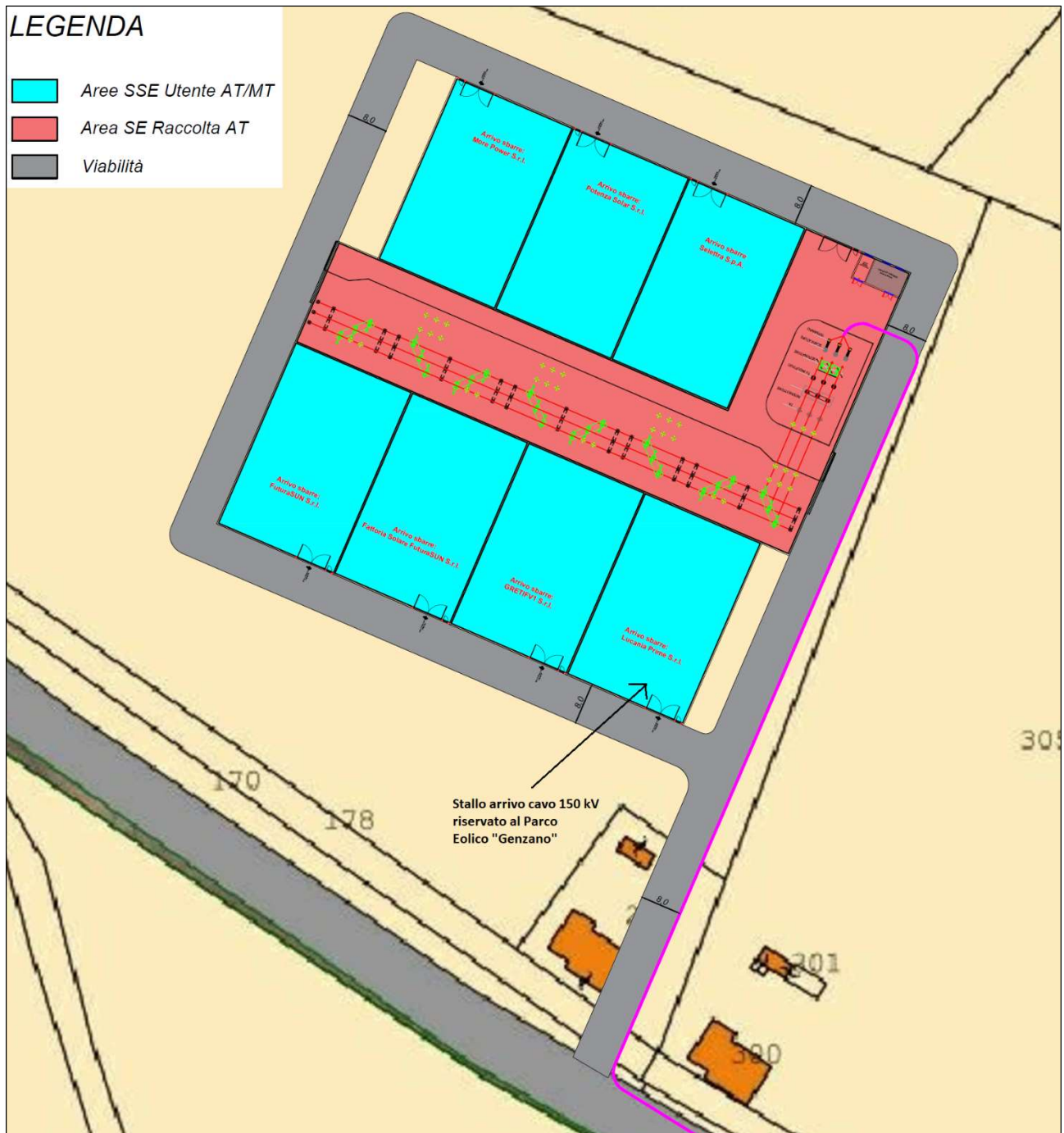
Figura 2.3.5.1: Layout della Stazione Elettrica Condivisa
