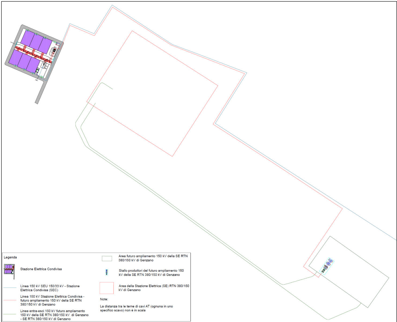
Figura 5.2.3: Dettaglio 2 – collegamento tra la SEC e l’ampliamento a 150 kV della SE RTN 380/150 kV e collegamento in entra-esci tra il medesimo ampliamento e la SE RTN 380/150 kV
