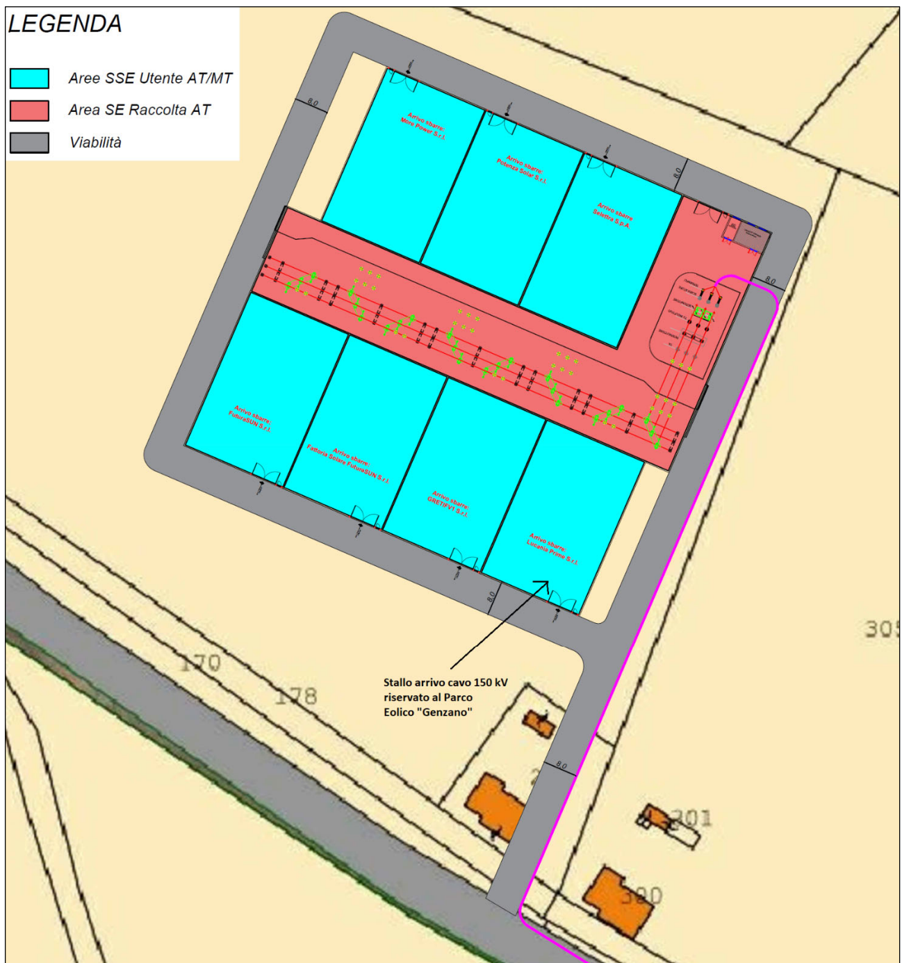
Figura 2.3.5.1: Planimetria elettromeccanica della sottostazione elettrica condivisa
