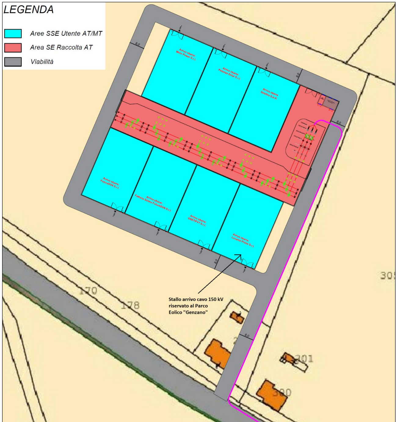
Figura 5.3.5.1: Planimetria elettromeccanica della Sottostazione elettrica condivisa
