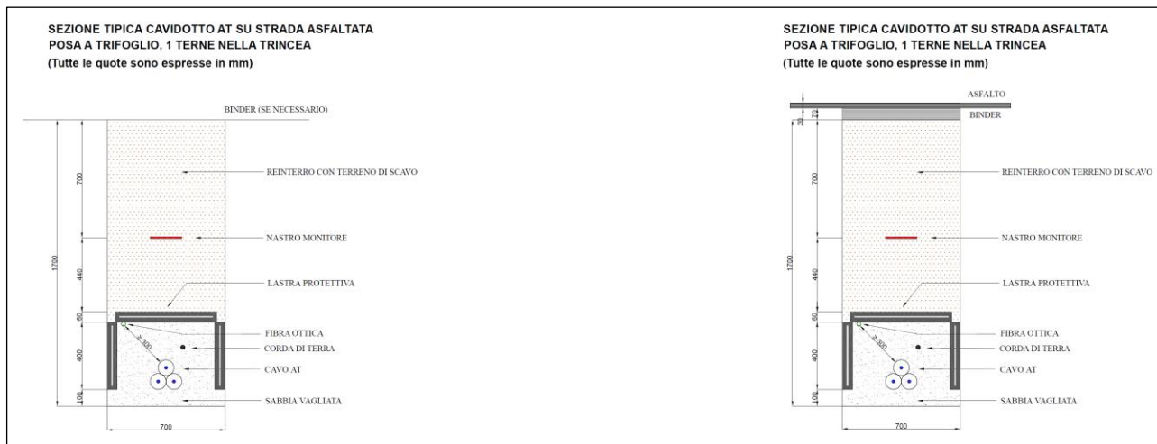
Figura 5.3.6.1: Sezione tipica del cavidotto AT
