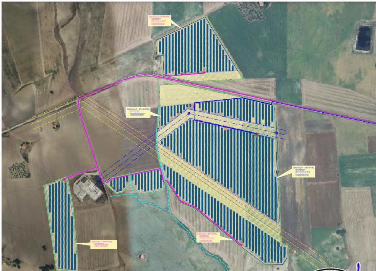
Figura 2: sito 1 - layout dell'impianto da realizzarsi
