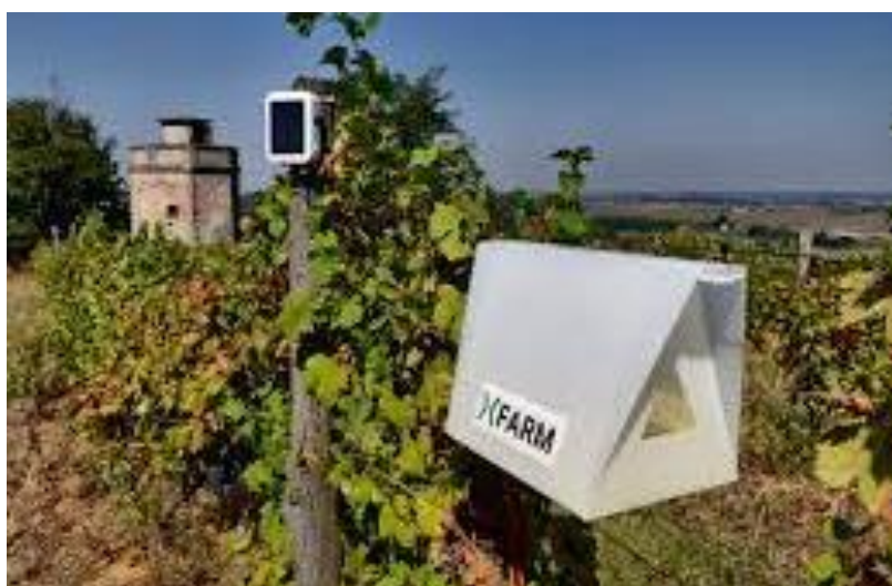
Figura21: trappole smart di rilevamento insetti dannosi
