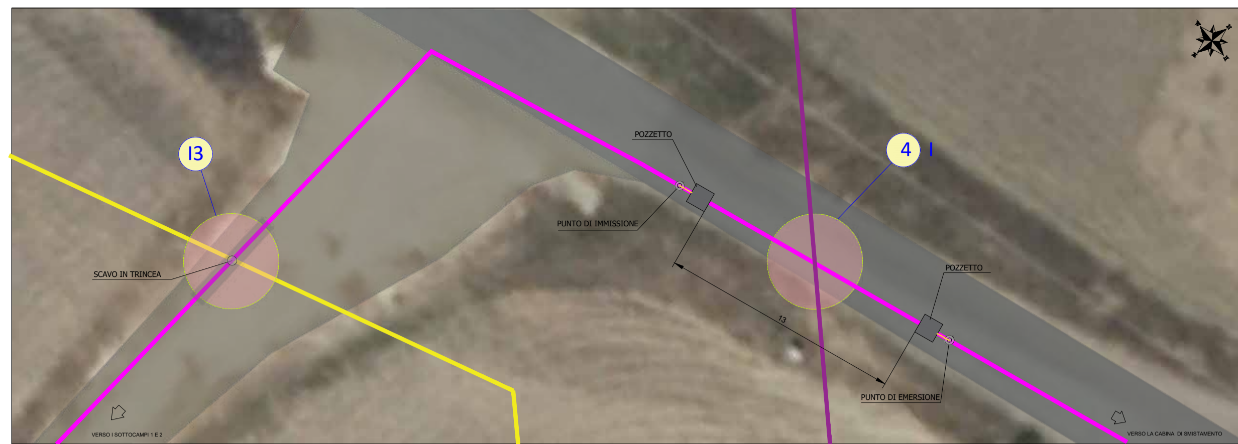
Interferenze 13, 14: Particolare attraversamento tramite T.O.C. (trivellazione orizzontale controllata) del Metanodotto SNAM "San Salvo - Bicari 3" DN 500 (20") 64 bar e con scavo in trincea del Metanodotto SNAM "Nuovo San Salvo - Bicari 3" DN 650 (20") 75 bar SCALA 1:200
