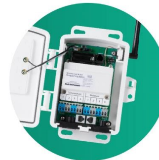
Stazione di bagnatura fogliare e umidità del suolo/temperatura
