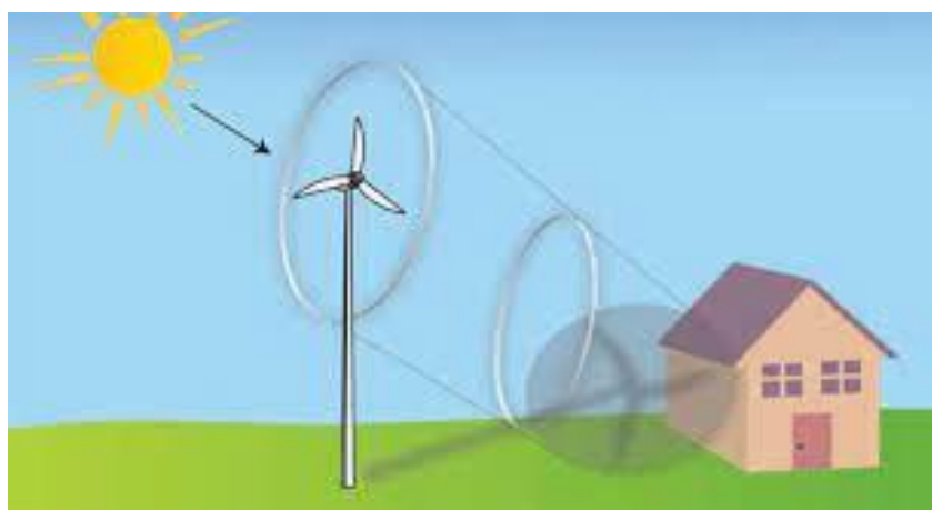
Figura 1: Rappresentazione schematica del fenomeno dello shadow flicker
