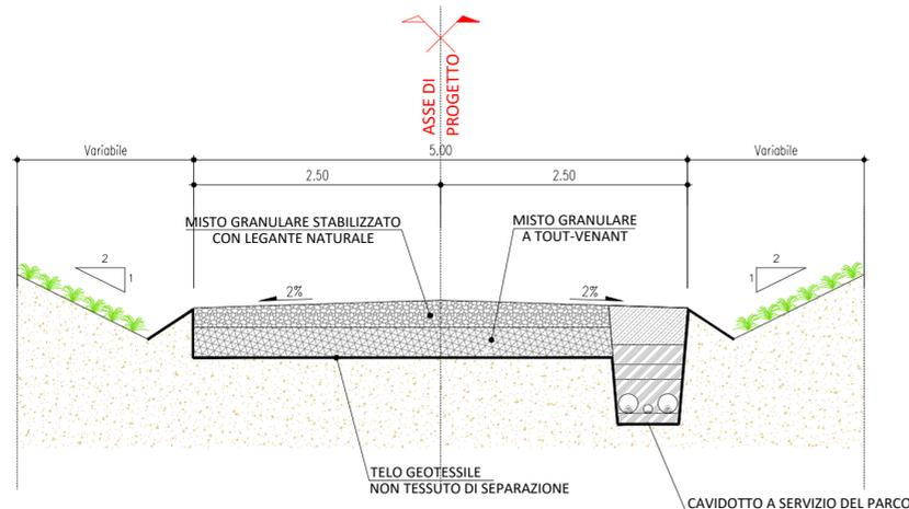
**SEZIONE IN RILEVATO**
