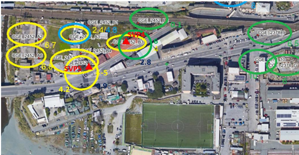
Figura 4.6. Indagini disponibili nei pressi dell'area di progetto, sia di progetto che bibliografiche. Con diverso colore è cerchiato il substrato (GIALLO - Argille di Ortovero; AZZURRO – Calcescisti; VERDE - Brecce), con relativa profondità da p.c., in blu è indicata la profondità della falda, qualora disponibile.
