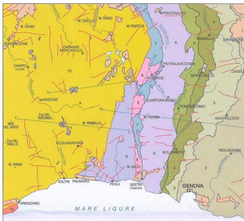
Figura 3-1 – Schema tettonico del nuovo foglio CARG 213-230 Genova: (1) Depositi tardo-posto orogenici, (2) Unità tettonica Antola, (3) Unità tettonica Ronco, (4) Unità tettonica Montanesi, (5) Unità tettonica Mignanego, (6) Unità tettono-metamorfica Figogna, (7) Unità tettono-metamorfica Cravasco-Voltaggio, (8) Unità tettono-metamorfica Gazzo-
