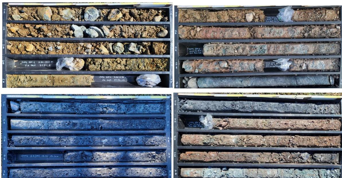
Figura 4-3 – Foto delle carote estratte dal sondaggio SVP4, da sinistra a destra e dall’alto in basso, rispettivamente: all’interno dei terreni di riporto e dei sottostanti depositi alluvionali, all’interno delle breccie tettoniche (compresa la carota quasi intera di un metro di calcescisti sani), all’interno della “grafite” grigio scura interpretata come calcescisti alterati e, di nuovo, nelle breccie tettoniche verso il fondo del sondaggio.
