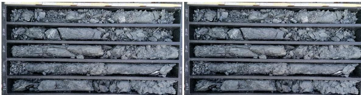
Figura 4-1 – Foto delle carote estratte dal sondaggio SVP1, da sinistra a destra e dall'alto in basso, rispettivamente: all'interno dei depositi superficiali associati ai terreni di riporto, all'interno del "cappellaccio di alterazione", nei calcescisti intensamente fratturati ( $0 < RQD < 50$ ) e permeati da abbondante frazione fine, argilloso-limosa ed, infine, in quelli sani, caratterizzati da buoni valori di RQD ( $75 < RQD < 100$ ).
