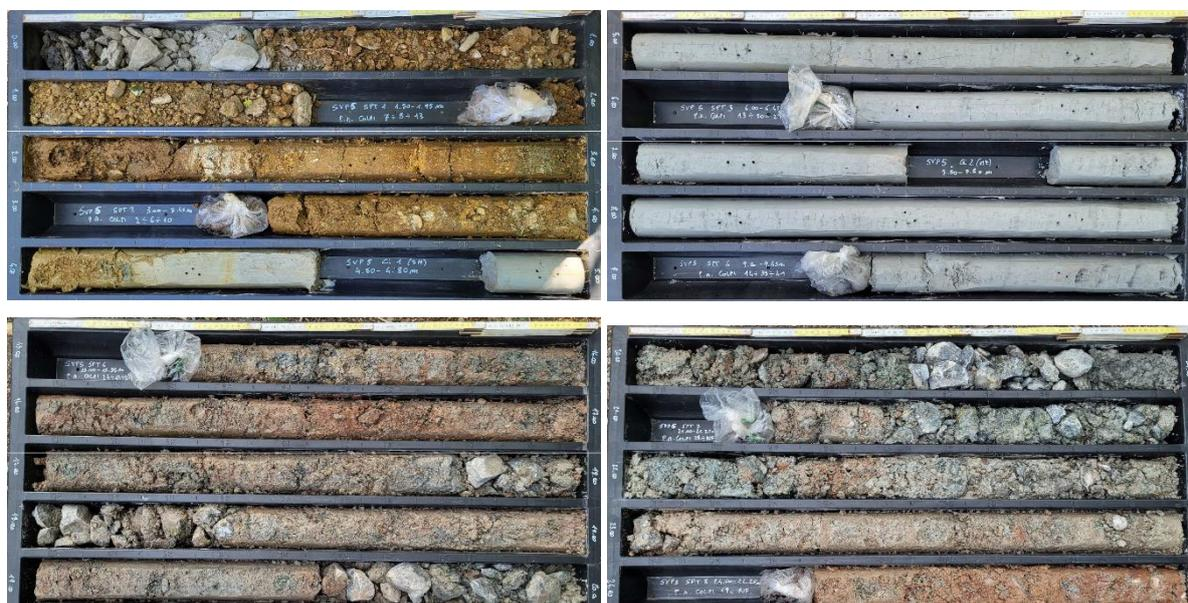
Figura 4-4 – Foto delle carote estratte dal sondaggio SVP5, da sinistra a destra e dall'alto in basso, rispettivamente: all'interno dei terreni di riporto e dei sottostanti depositi alluvionali, all'interno delle Argille di Ortovero e nelle brecce tettoniche caratterizzate da gradi diversi di alterazione (diverse sfumature dal grigio-verdastro al bruno-rossastro e da percentuali variabile di matrice fine).
