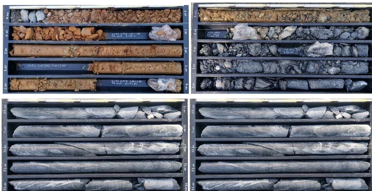
Figura 4-2 – Foto delle carote estratte dal sondaggio SVP2, da sinistra a destra e dall’alto in basso, rispettivamente: all’interno dei depositi superficiali associati ai terreni di riporto, all’interno del “cappellaccio di alterazione”, nei calcescisti sani, caratterizzati da ottimi valori di RQD (spesso compresi tra 90 e 100) e nei calcescisti maggiormente fratturati verso fondo foro (gli ultimi 2m, caratterizzati da un RQD non superiore al 10%).
