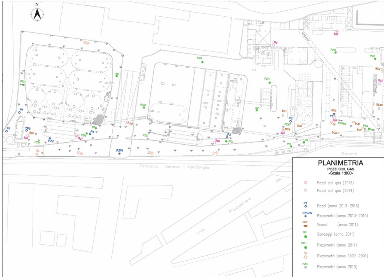
Figura 2-1 Ubicazione delle indagini geognostiche
