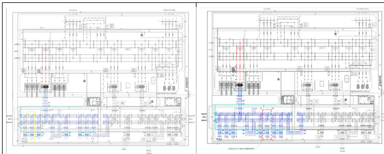
PLANIMETRIA STAZIONE RTN "ERCHIE" E RELATIVO AMPLIAMENTO DELLA SEZIONE A 150 kV A sx evidenziato in giallo lo stallo assegnato con la prima soluzione di connessione, a destra in rosso lo stallo assegnato a seguito della variazione della soluzione di connessione
