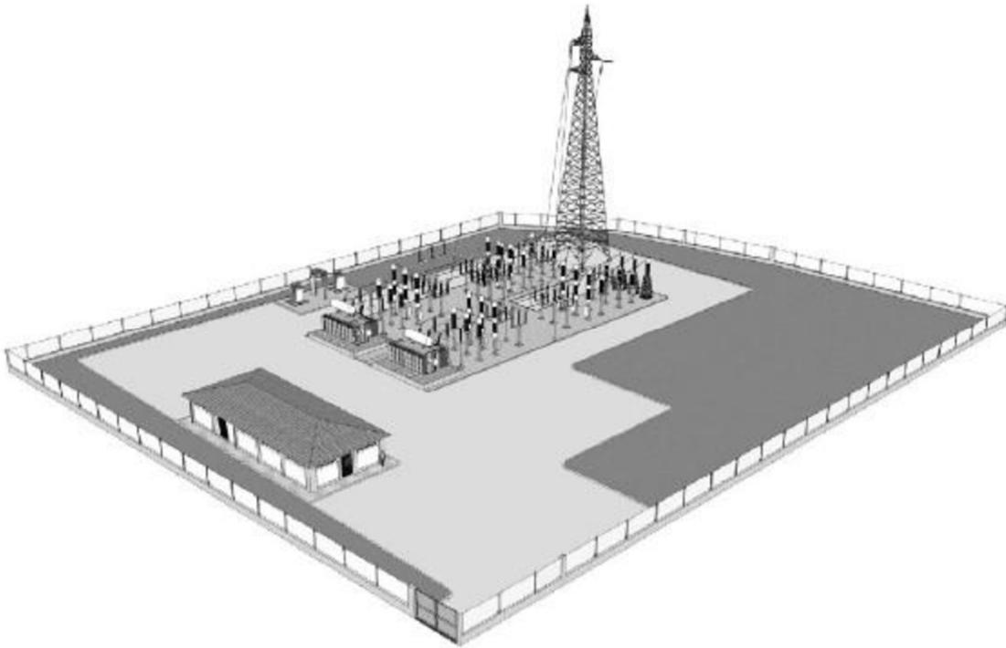
**Fig. 3a: Rappresentazione di una tipica Stazione di Utanza 150/20 kV con apparecchiature isolate in aria**
