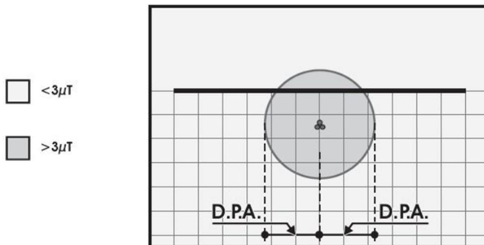
**Fig. 7b – Rappresentazione delle fasce di rispetto per interrimento "a trifoglio" di semplice terna in cavo**
