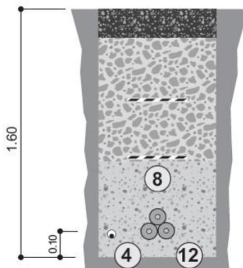
**Fig. 7a – Rappresentazione di interrimento "a trifoglio" di una semplice terna in cavo unipolare esercita a 150 kV**
