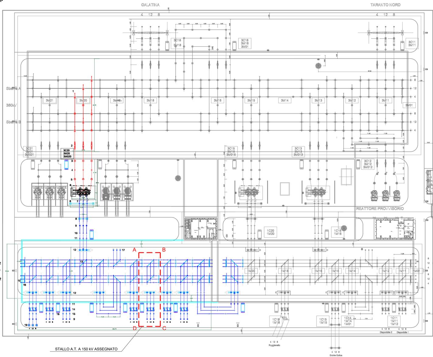
PLANIMETRIA STAZIONE RTN "ERCHIE" E RELATIVO AMPLIAMENTO DELLA SEZIONE A 150 kV - SCALA 1:500
