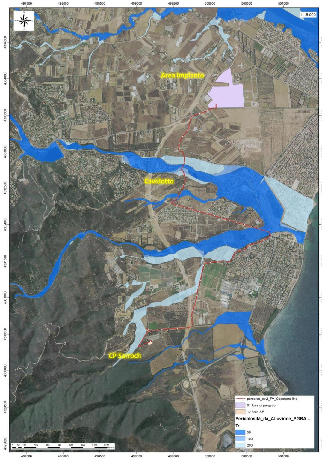
Figura 10.2 - Inquadramento PGRA dell'area interessata dal cavidotto di connessione alla sottostazione CP Sarroch.
