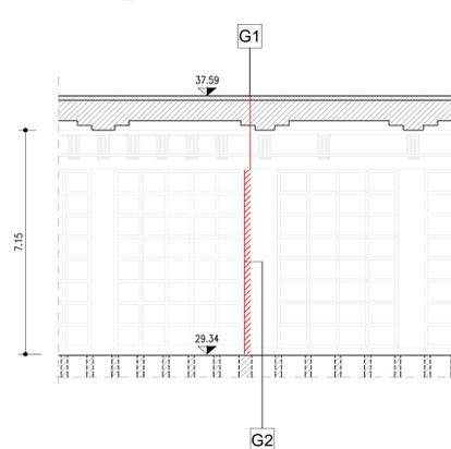
PARTICOLARE G1 RIPRISTINO GIUNTO STRUTTURALE ORIZZONTALE - scala 1:2
