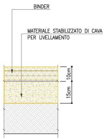
Figura 4-3. Particolare pavimentazione del cantiere CO03C da demolire
