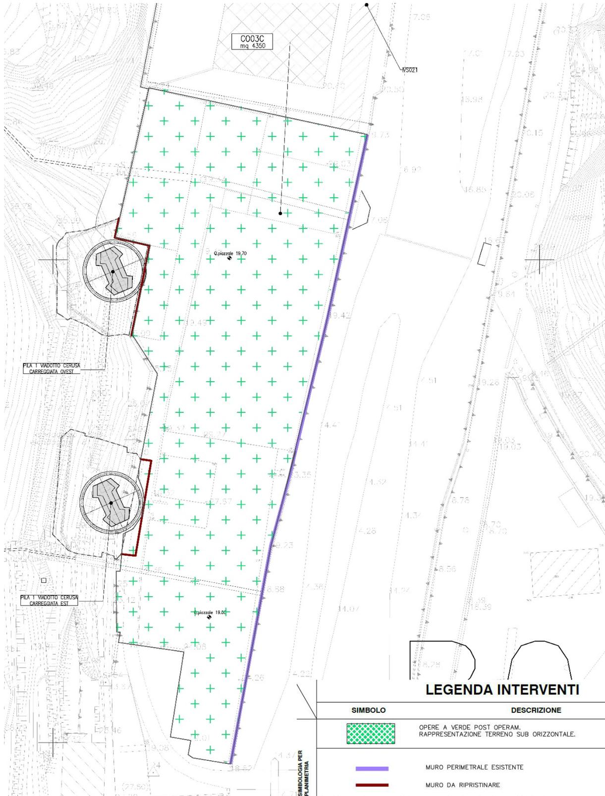
Figura 4-4. Planimetria cantiere CO03C con interventi di ripristino
