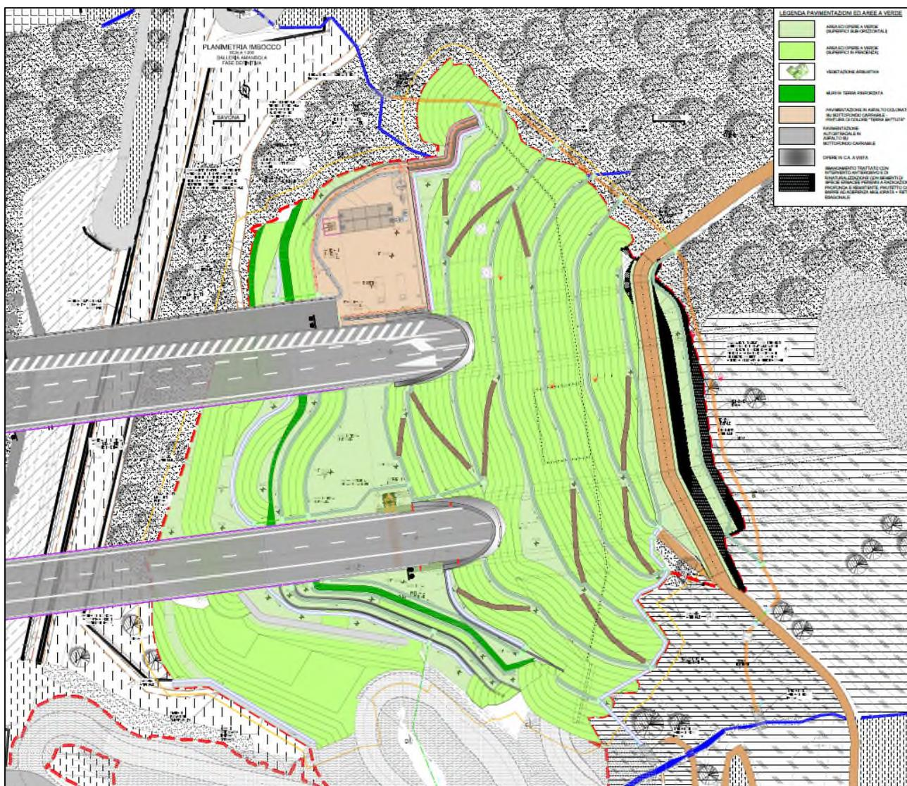
Figura 4-80 – Planimetria stato finale dell'area di imbocco (fonte: elaborato 110728-LL8C-PE-A1-G06-GF06W-SSF00-D-AUA1971-1)
