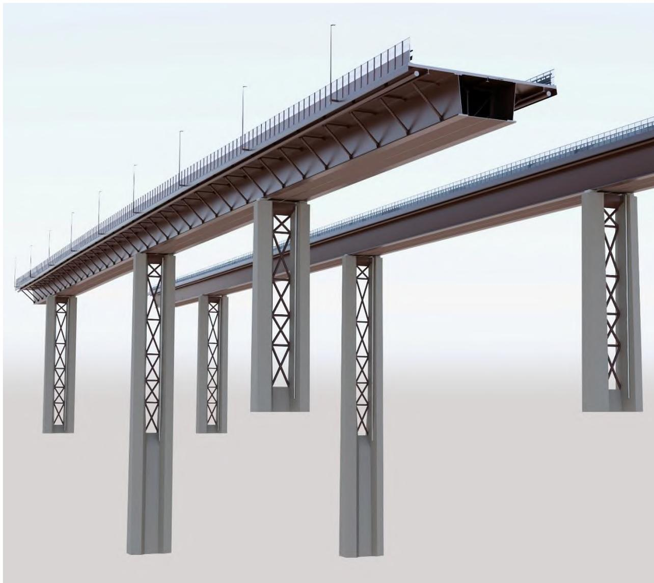
Figura 9-34. Assonometria di studio aspetto pile e impalcato.
