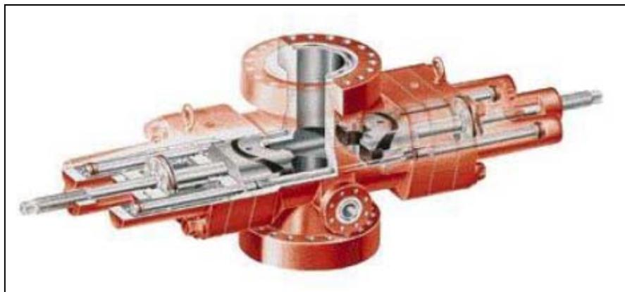
**Figura 4.10: Schema BOP Tipo**
