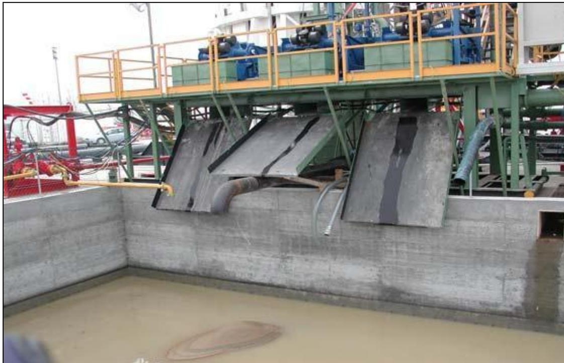
**Figura 4.20: Scarto e Raccolta Detriti e Fango di Perforazione**
