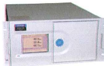
In automatico l'analizzatore calcola il tenore di NO<sub>2</sub> per semplice differenza
