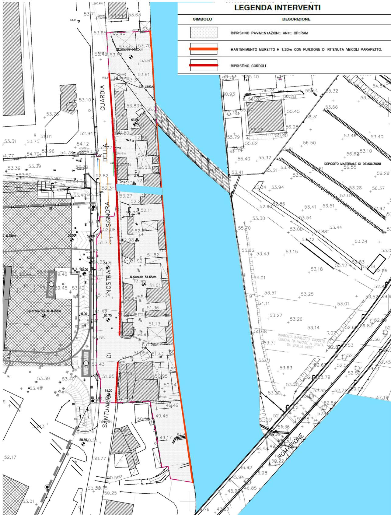
Figura 4-3. Planimetria cantiere CI013 con interventi di ripristino
