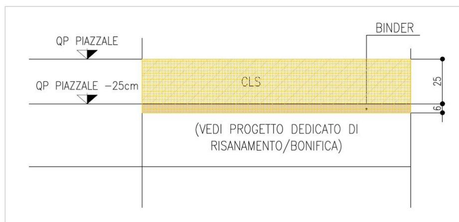
Figura 4-1. Particolare pavimentazione del cantiere CI013 da demolire
