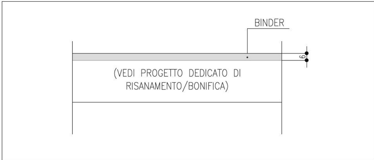
Figura 4-4. Particolare pavimentazione del cantiere CI010 da ripristinare
