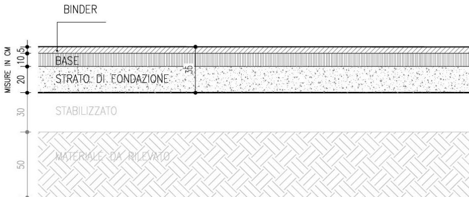
Figura 3-4. Esempio di pavimentazione di cantiere ripristinata
