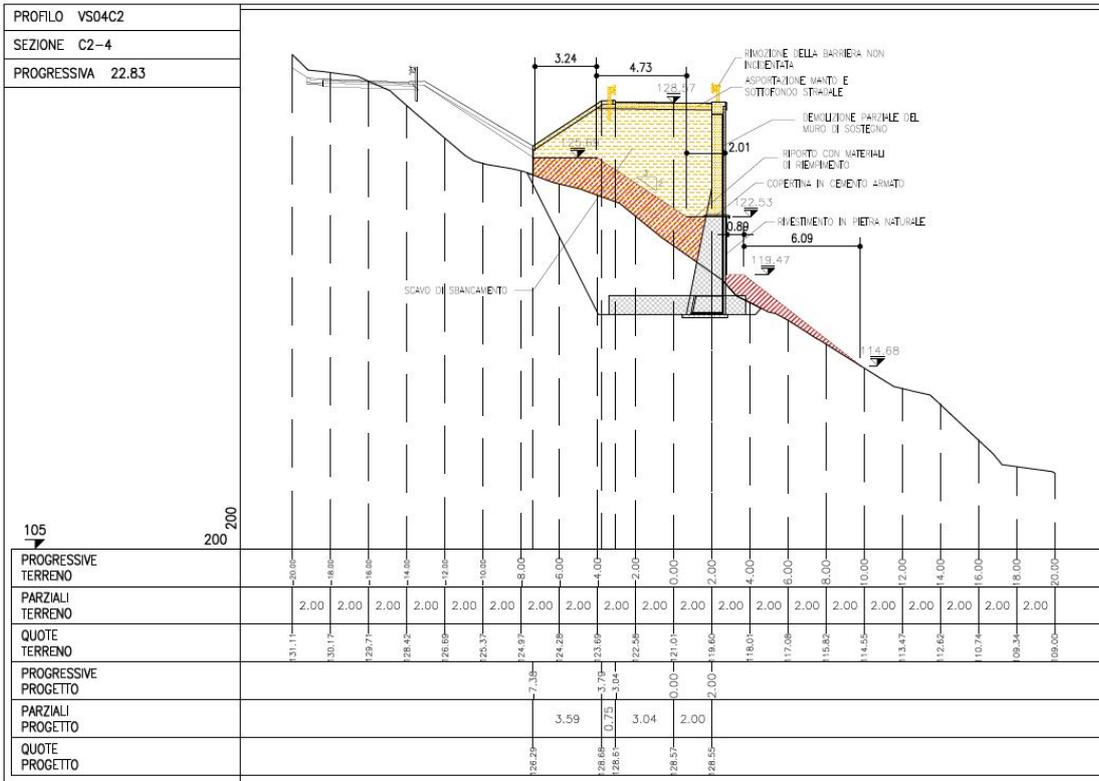
Figura 4-2. Sezione C2-4
