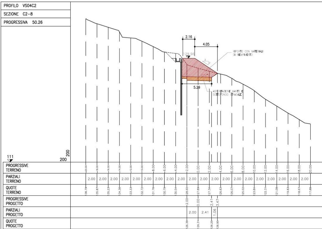
Figura 4-3. Sezione C2-8
