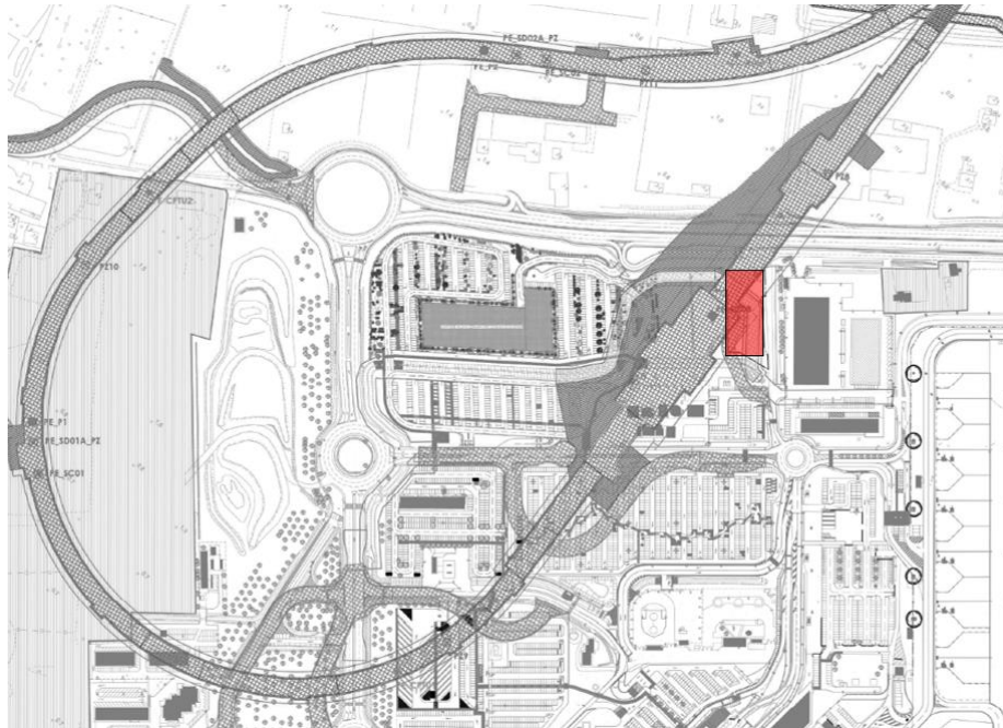
Figura 3-8 Interferenza tra l'attuale area di deposito (in rosso) ed il tracciato ferroviario
