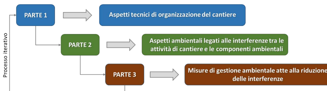
Figura 1-2 Schema logico per la gestione della cantierizzazione
