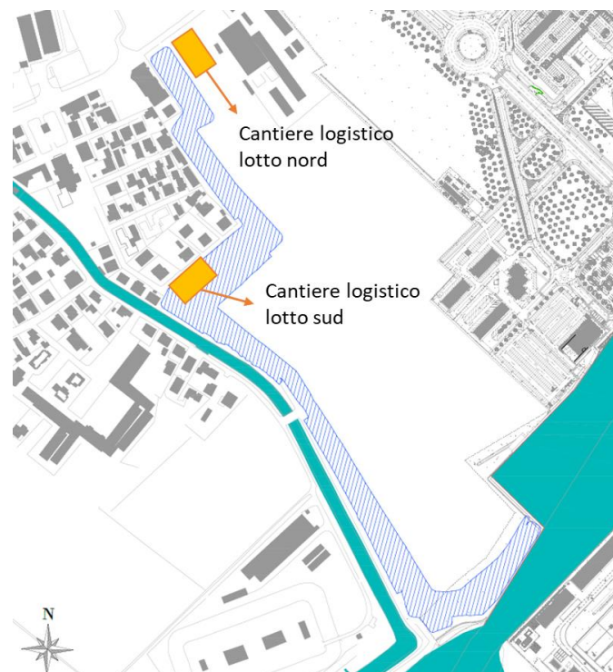
Figura 5-2 Localizzazione cantiere logistico terrapieno vegetato
