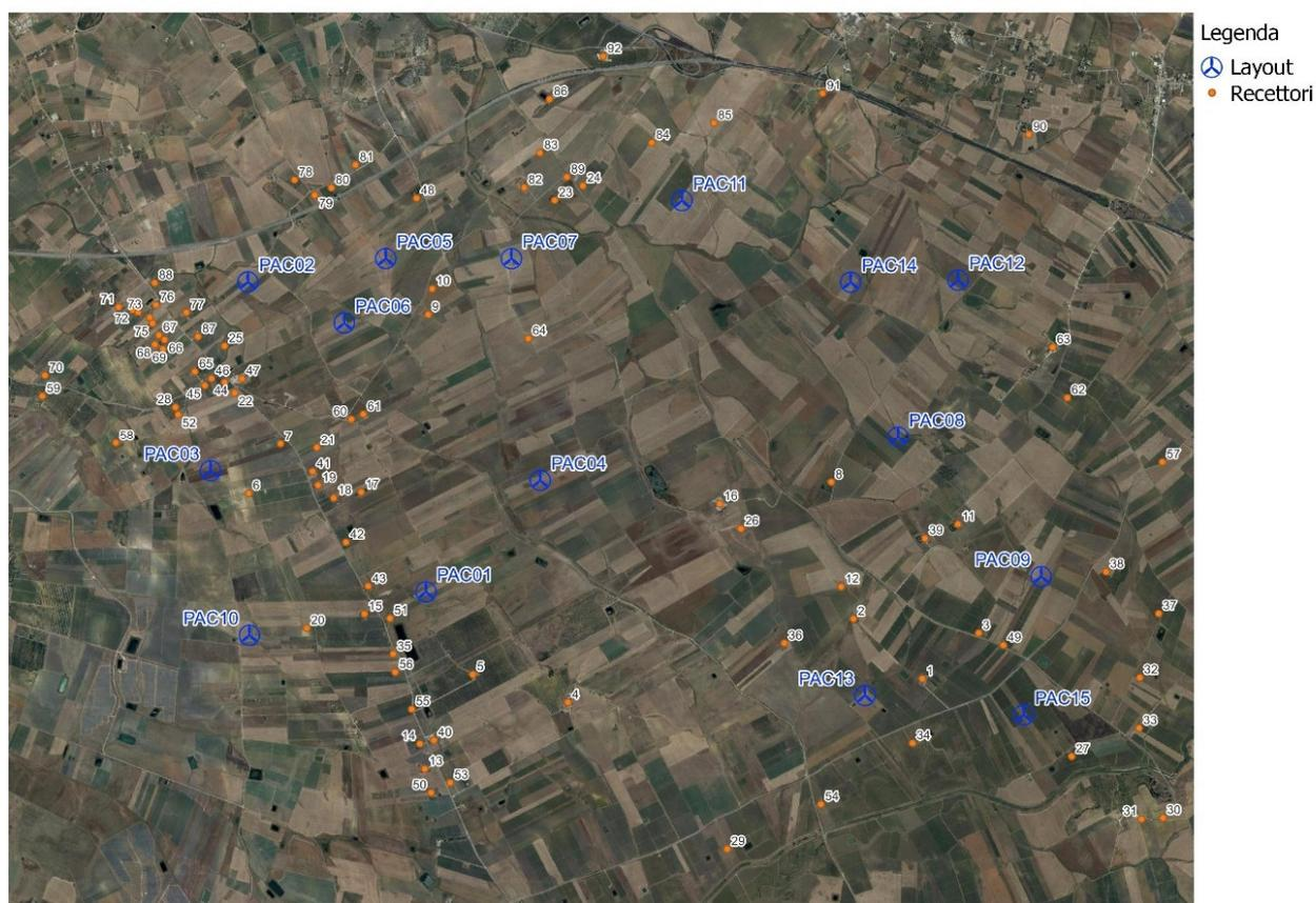
Figura 3.1: Individuazione dei recettori all'interno dei buffer di 1.500 m dalle WTGs in progetto
