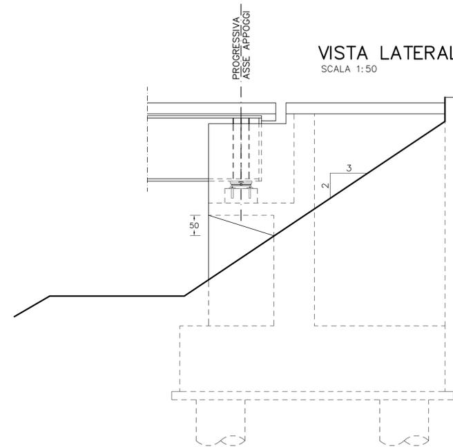
PARTICOLARE TRANSIZIONE SPALLA-RILEVATO
