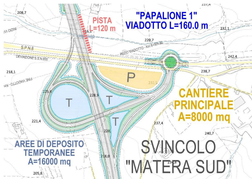
Planimetria ubicazione Cantiere principale
