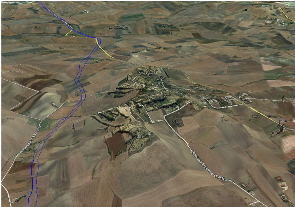
Fig.6.6 . Rilievo di Contrada Serra d'Alto, a NE di Matera, il cui top è impostato sulle Calcareniti di Monte Castiglione, poggianti sulle Argille Subappennine. Immagine da Google Earth, vista da W (tracciato di progetto Soluzione A riportato con linee blu).
