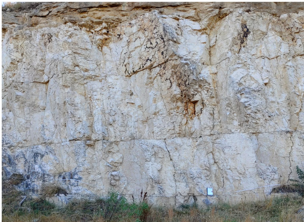
Fig. 5.4 . Calcarea di Altamura al passaggio con le Calcareniti di Gravina soprastanti, fronte di ex cava in loc. Masseria del Duchino nei pressi del tracciato A a NO di Matera
