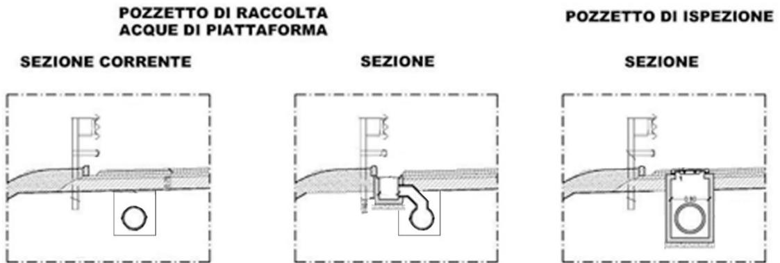
Nei tratti di rilevato in curva, gli accorgimenti sono del tutto simili, prevedendo per la raccolta delle acque di piattaforma il posizionamento, in funzione della pendenza trasversale della strada, di un collettore nel lato esterno della carreggiata e di uno in corrispondenza dello spartitraffico centrale, dove si inseriscono delle caditoie con interasse massimo di 15 m. La manutenzione del collettore centrale è resa possibile dalla disposizione di pozzetti ad interasse massimo di 50 m.
