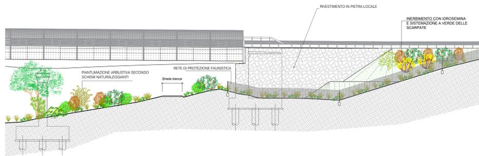
SEZIONE TIPO SISTEMAZIONI IN RILEVATO CON OPERE DI SOSTEGNO
