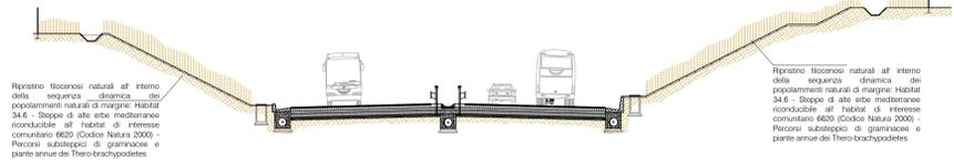
SEZIONE TIPO IN RILEVATO CON TOMBINO DI ATTRAVERSAMENTO FAUNISTICO
