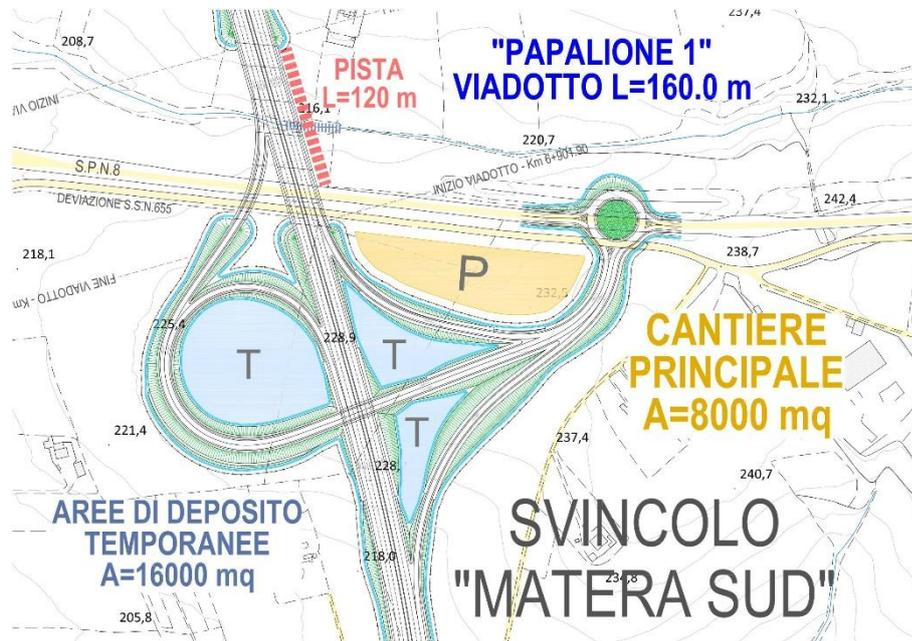
Figura 4.4 Layout cantiere principale
