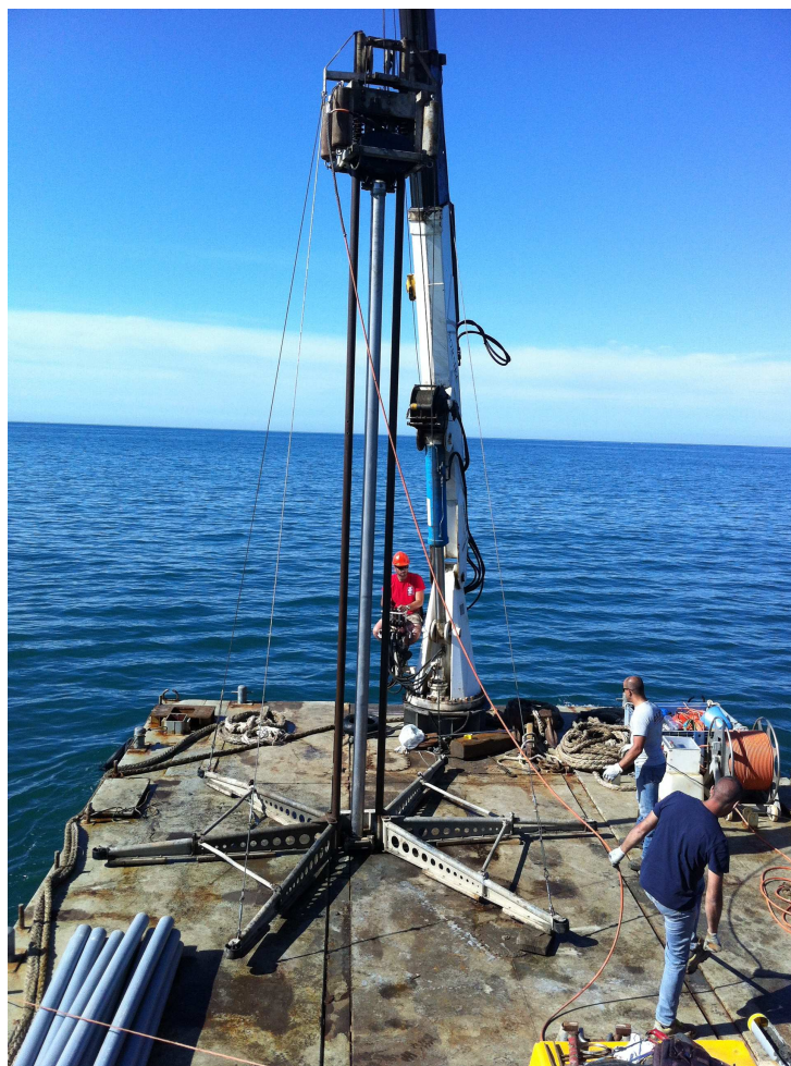
Foto21 (Carotiere Geo Corer 3000/6000 in fase di campionamento)
